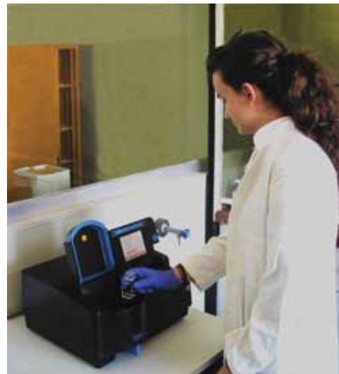
Φασματοφωτόμετρο για τον προσδιορισμό χημικών παραμέτρων σε δείγματα νερού.
