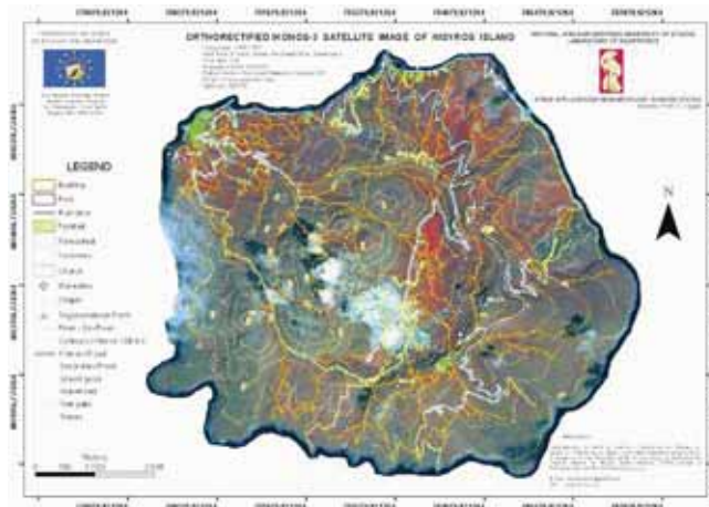
Ορθο-φωτοχάρτης Νισύρου με υπόβαθρο την δορυφορική εικόνα ορθο-IKONOS-2 (2000, ανάλυση 1m, Σύστημα Αναφοράς ΕΓΣΑ'87) και την τοπογραφική πληροφορία (οδικό δίκτυο, κτήρια κ.ά. ανά κατηγορίες) προερχόμενη από φωτοερμηνεία και εργασία πεδίου.
