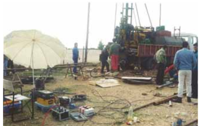
Σεισμικές μετρήσεις cross hole και σεισμικής τομογραφίας.
