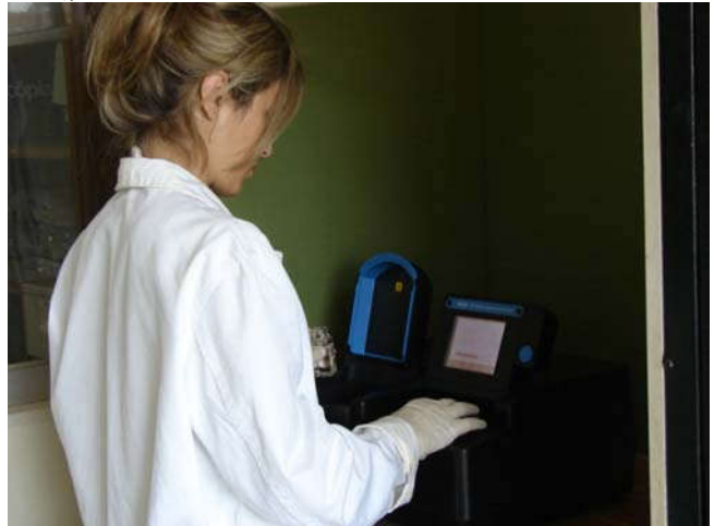
Φασματοφωτόμετρο (Hach Dr-4000) για τον καθορισμό χημικών παραμέτρων σε δείγματα νερού.
