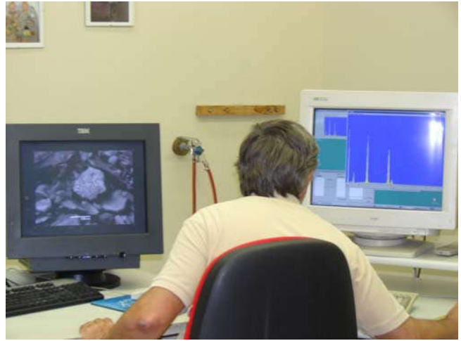
Ηλεκτρονικό μικροσκόπιο σάρωσης (SEM) εφοδιασμένο με σύστημα EDS.
