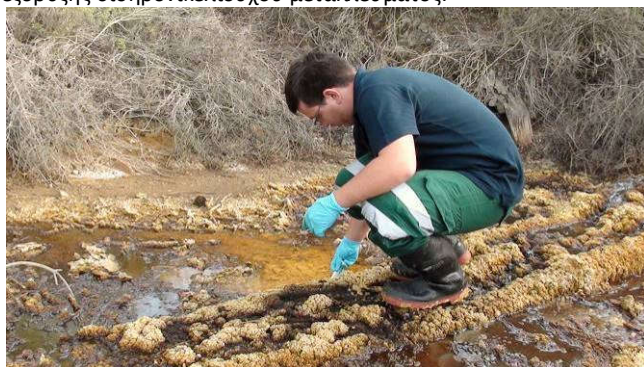
Δειγματοληψία ύδατος όξινης απορροής μεταλλείων στην περιοχή Καλαβασσού Κύπρου.
