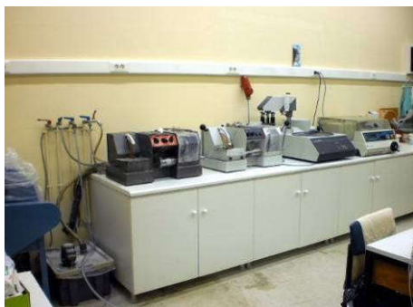
Τα μηχανήματα της Μονάδας κοπής και λείανσης λεπτών τομών του Εργαστηρίου.
