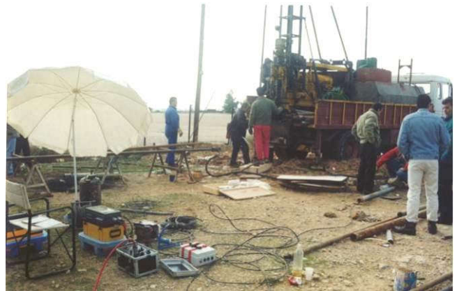
Σεισμικές μετρήσεις cross hole και σεισμικής τομογραφίας.
