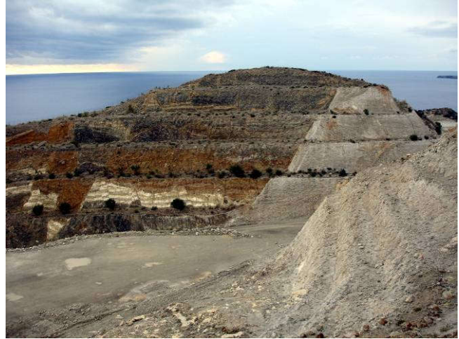
Ορυχείο ποζολάνης στη περιοχή Ξυλοκερατιά της νήσου Μήλου. Έντονος τεκτονισμός έχει επηρεάσει Πλειοκαινικά τοφφικά πετρώματα και λευκές ενστρώσεις διατομιτών.
