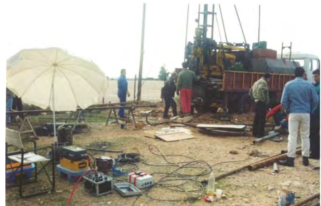
Σεισμικές μετρήσεις cross hole και σεισμικής τομογραφίας.
