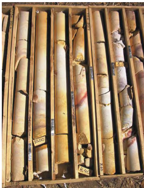
Πυρήνες γεώτρησης από κοιτάσμα επιθερμικού χρυσού (Θράκη)
