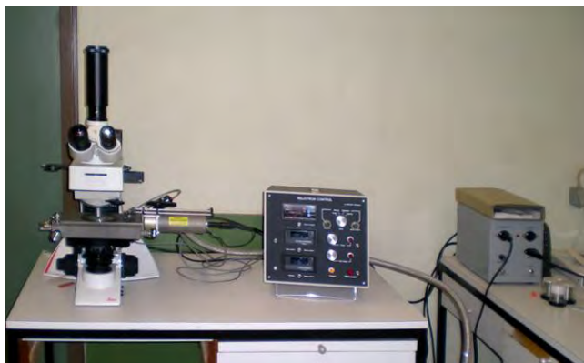
Συσκευή οπτικής καθοδοφωταύγειας (Optical-CL).
