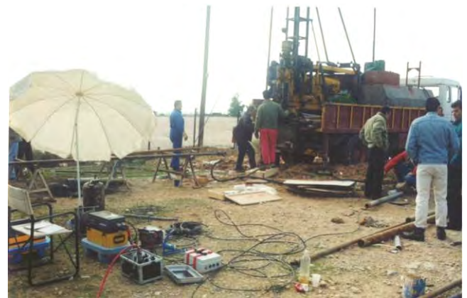
Σεισμικές μετρήσεις cross hole και σεισμικής τομογραφίας.
