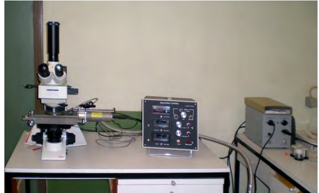
Συσκευή οπτικής καθοδοφωταύγειας (Optical-CL).
