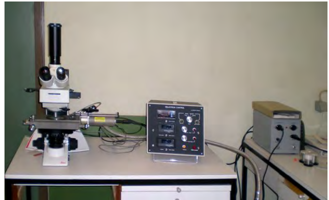
Συσκευή οπτικής καθοδοφωταύγειας (Optical-CL).
