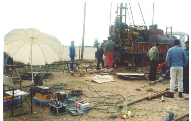
Σεισμικές μετρήσεις cross hole και σεισμικής τομογραφίας.
