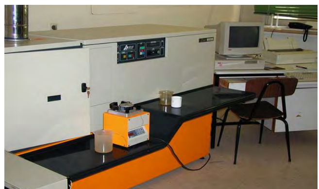
Φασματοσκόπιο εκπομπής με διέγερση πλάσματος (ICP-AES)
