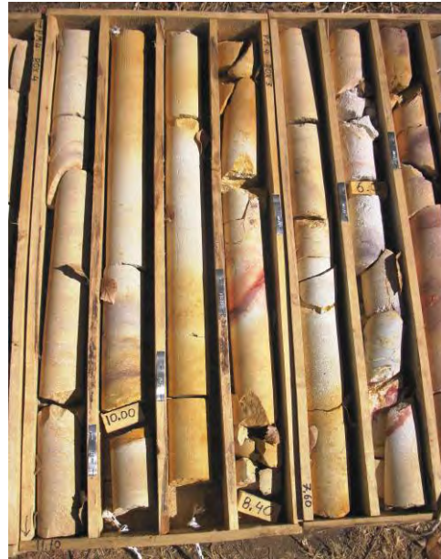
Πυρήνες γεώτρησης από κοίτασμα επιθερμικού χρυσού (Θράκη)
